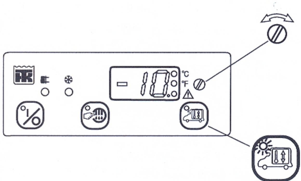
**ВНИМАНИЕ:** заданная температура может быть изменена поворотом рукоятки регулировки заданной температуры и в режиме, когда кнопка заданной температуры не нажата.
